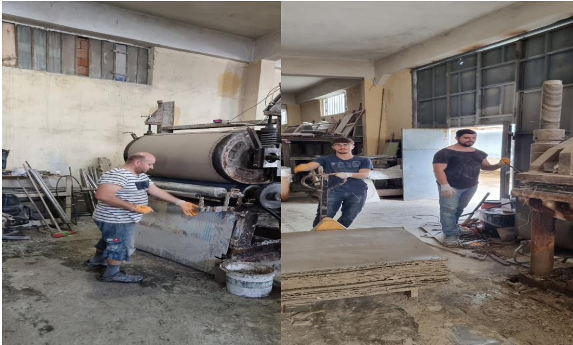
Şekil 12. Dolgu, İzolasyon ve Keçe Tabaka Üretimi
